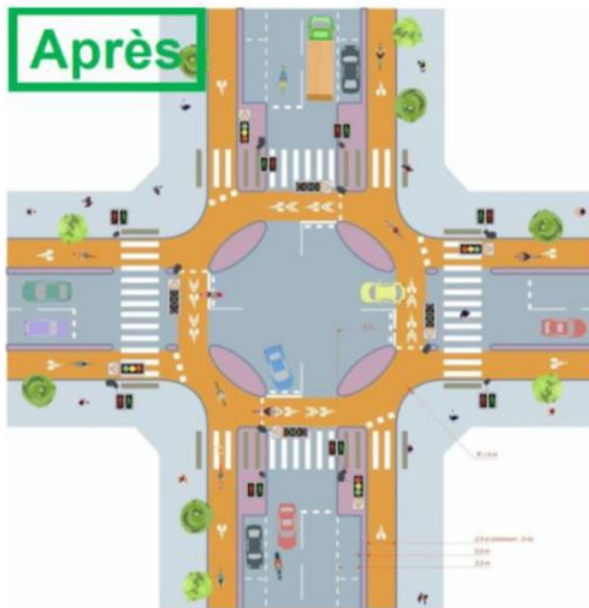
Figure 25 : Carrefour à feux à ilots-amandes (intersection majeure)
